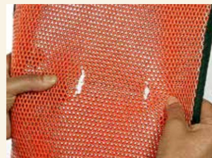
Brustschutz: steckt noch in den Kinderschuhen. Das Brustgitter von Klim scheitert bei halber Normbelastung
