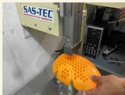
Härtetest: Fünf Kilo Stahl fallen aus einem Meter Höhe auf den Protektor
