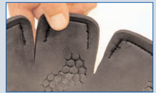
Zerstört: Hartschalen- und Styroporprotectoren halten nur einen Schlag aus
