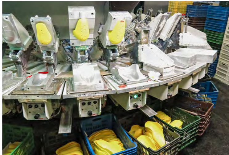
Blick in die Produktion bei Sas-Tec. Via Roboter wird die Masse in vorgeheizte Formen gespritzt, reagiert dort und plustert sich in engen Kennlinien zum waschechten Protektor auf. Stimmt nur ein Parameter nicht, ist der Diva-Schaum beleidigt
