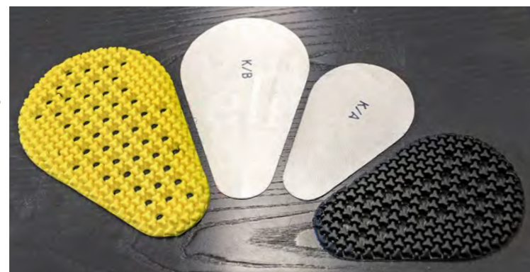
Wie im echten Leben kommt es auch bei Protektoren auf die Größe an. Mittig in Weiß sind die Schablonen nach Norm. Findige Hersteller machen ihre Protektoren keinen Deut größer und damit auch schwerer
